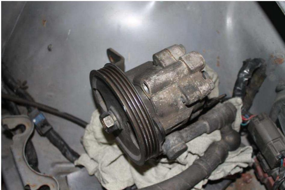
エンジnbロックからパワーステアリングマウントを取り外します。
