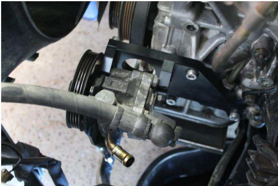
ポンプを押し下げてプーリーにベルトを滑り込ませます。ベルトを入れることができない場合は、プーリーをポンプから取り外し、プーリーをベルトとともに同時に取り付けます。
