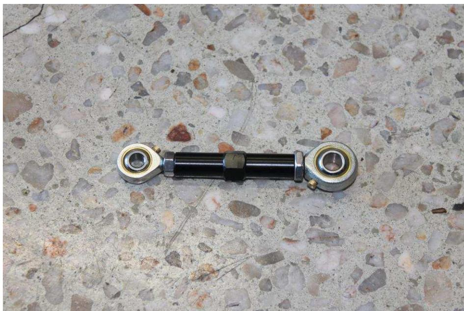
付属のM8ボルトを使用して、ブラケットとローズジョイントとナイロンロックナットの間にニッケルメッキされたワッシャを使用して、アジャスタをパワーステアリングポンプに取り付けます。
