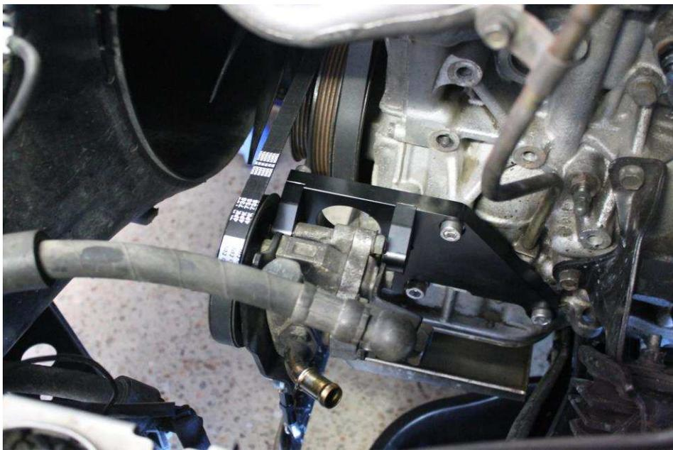
ポンプを持ち上げ、付属のM8ボルトを使用しながら、アジャスターをスプリットワッシャーとワッシャーでブラケットに固定します。
