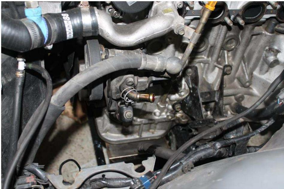
パワーステアリングポンプブラケットのテンショナーを緩め、ベルトを取り外します。
