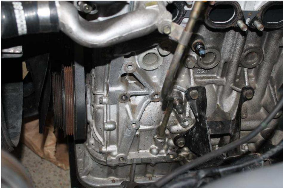
付属の3本のM10ボルトとスプリットワッシャを使用して、ブラケットをエンジンブロックに取り付けます。
