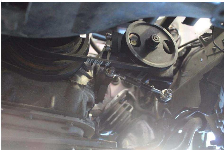
必要に応じてアジャスターを回してベルトのたるみを取り除きます。ブラケットにポンプを保持しているメインボルトを締め付けると、ベルトにさらに張力が加わることに注意してください。
