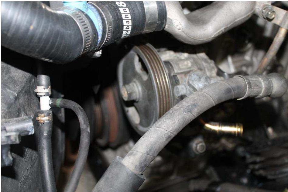
ポンプをブラケットに固定しているすべてのボルトを取り外し、ポンプを片側に移動します。
